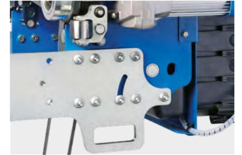
Der komfortable Klappmechanismus macht die Montage des Seilzuges am Kran ganz einfach.
