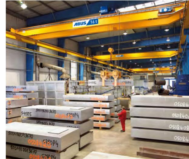
Zweischienenlaufkatzen der Bauart D auf Zweiträgerlaufkränen.
