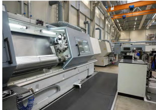
Mechanische Bearbeitung des Seilzug-Gehäuse auf 4-Achsen Fräszentren
