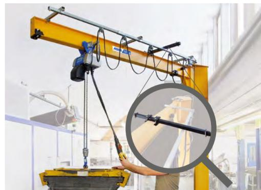
Schwenkansschlag Pufferstange (Bild 4)
