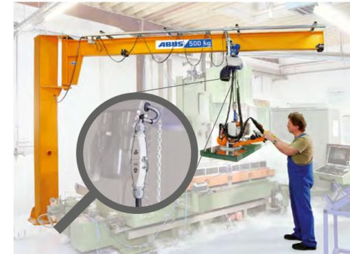
Schwenkkrane mit Vakuumgerät u. Stecker (Bild 13)
