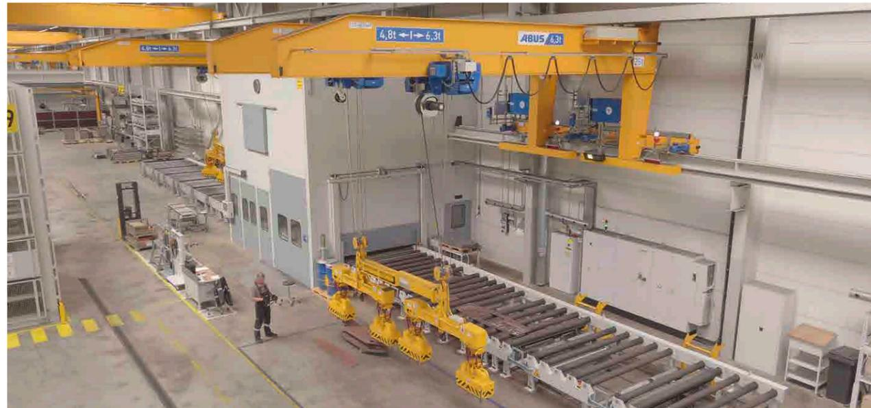
Auf der SPS-gesteuerten Schweißanlage werden die Bleche für Kastenträger in der erforderlichen Länge zusammengeschweißt. Die Stumpfnahtschweißanlage verarbeitet Bleche in verschiedenen Stärken, das automatische Nahtfolgesystem garantiert hierbei Schweißnähte von höchster Qualität.
