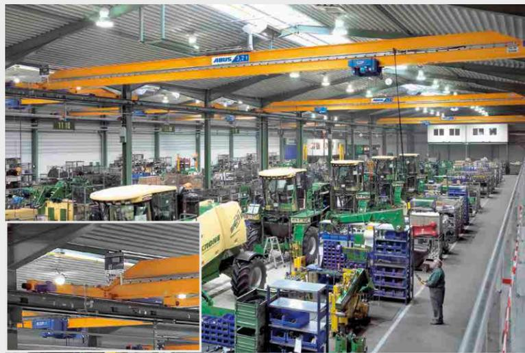
Die ideale Lösung für Hallenneubauten: der ABUS Einträgerlaufkran ELK mit an die Voute angepasster Hauptträgerschräge. Auf diese Weise wird die verfügbare Hallenhöhe optimal genutzt.
