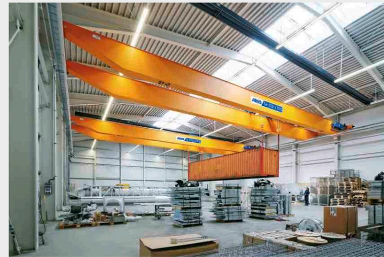
Beim Transport von langen und sperrigen Gütern sorgen zwei gleichlaufende Krane für ein risikofreies Lastenhandling.
