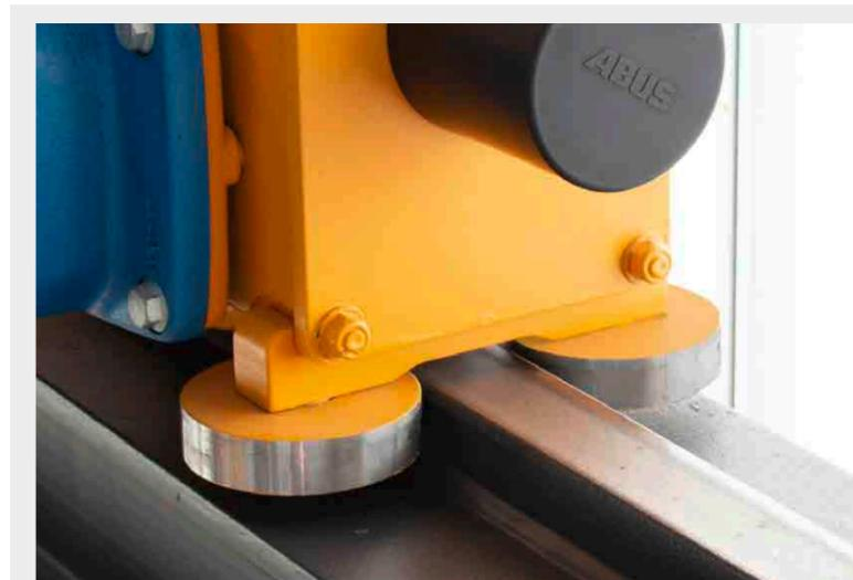
Führungsrollen am oberen Fahrwerks-
