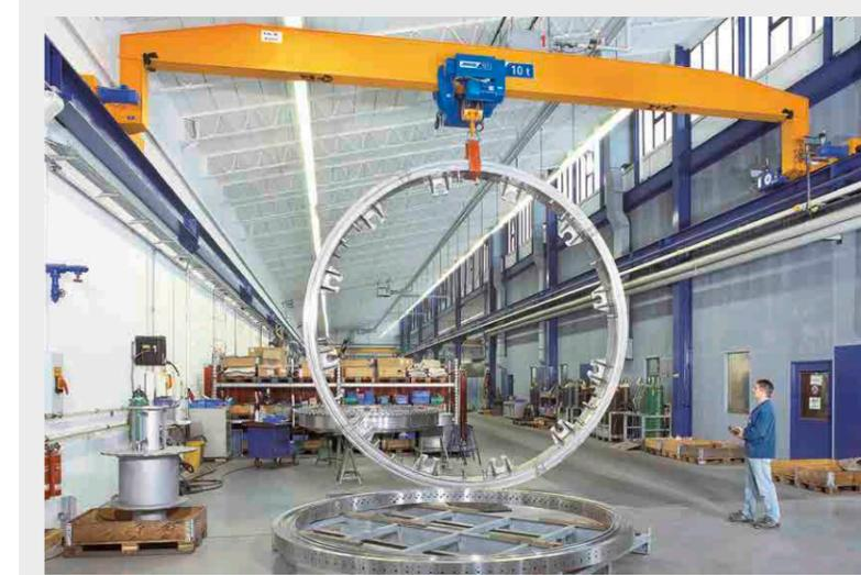
Bei besonderen architektonischen Situationen und baubedingten Vorgaben bieten aufgebockte Kranbrücken optimierte Einbaulösungen.
