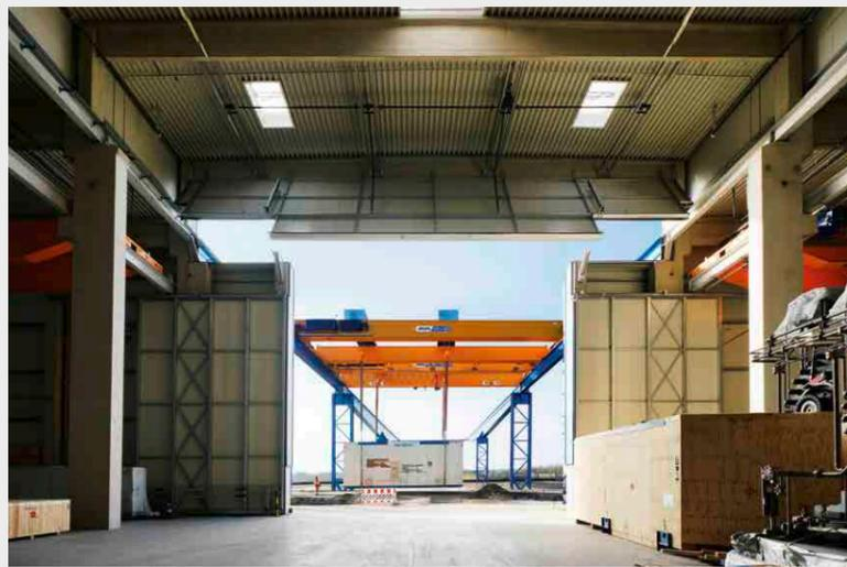
Bei Fahrten ins Freie sorgt eine über den ABUS Laufkran bediente Schaltung für die Steuerung der Kranklappenverriegelung.
