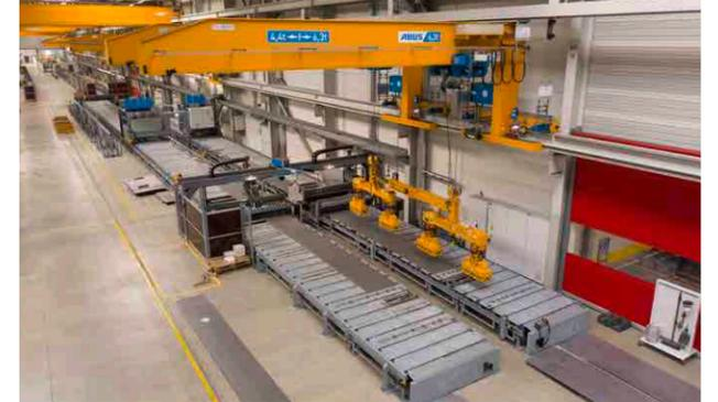
Vor der Weiterverarbeitung werden die Stegbleche mit aufgeschweißten Beulsteifen stabilisiert. Schottbleche geben der Gesamtkonstruktion eine optimale Formstabilität. Nach dem Aufbau auf der Kastenträgerbahn ist der Kastenträger für die Portalschweißanlage vorbereitet.
