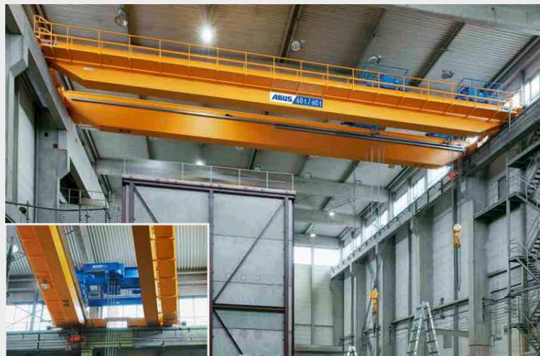
Durch die Lagerung des Fahrwerksträgers auf acht Rädern wird eine besonders günstige Lastverteilung erzielt. Damit können bei gleicher Kranbahn größere Lasten transportiert und eine sonst erforderliche Verstärkung bei vorhandenen Hallen gegebenenfalls vermieden werden.
