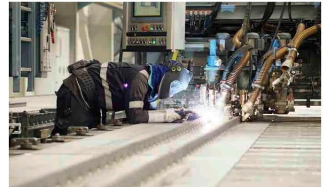
Die von ABUS konstruierte verfahrbare Portalschweißanlage setzt zur Verschweißung der Stegbleche mit Ober- und Untergurt und der Katzschienen auf der Trägeroberseite bis zu acht Schweißnähte gleichzeitig. Die Hochleistungsbrenner werden per SPS automatisch gesteuert.
