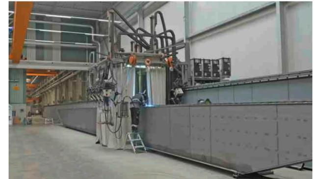
Nach dem Schweißen von Abschlussblechen und der Montage der Fahrwerksträger erhält der Kran zum guten Schluss das der jeweiligen Anforderung entsprechende Lacksystem.
