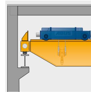
Serienhauptträger-Anschluss in Kombination mit abgesenkter Katze
